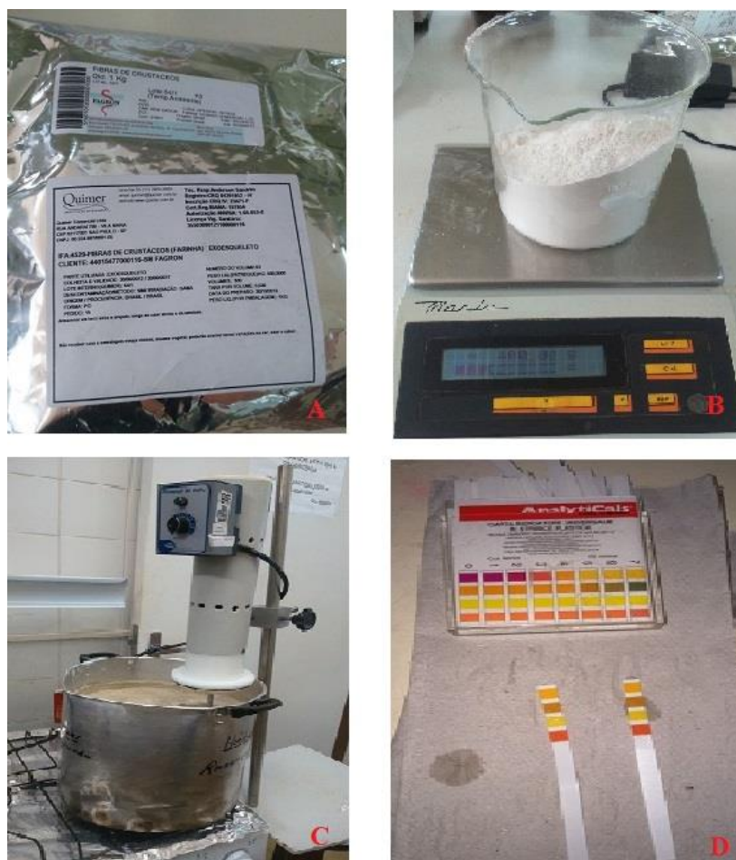
FIGURA 8. Preparo da solução de quitosana a 4%. A - Quitosana comercial; B - Pesagem da quitosana; C - Dissolução em água destilada, em agitação constante e fervura; D – Detalhe da aferição do pH a 5,5. Dourados – MS. 2015.
